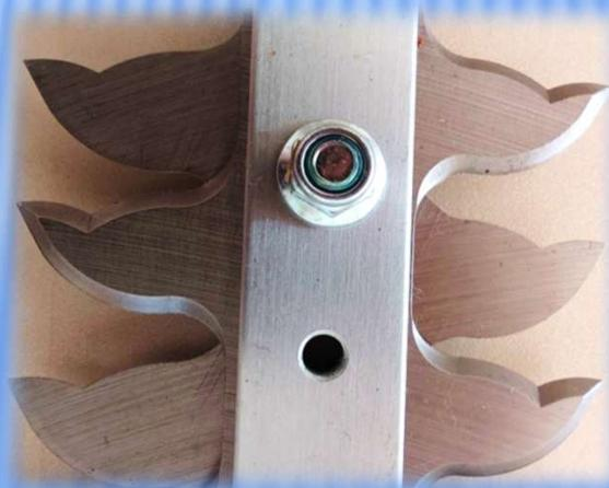
鍛造により刃付けをしたバリカン刃の例
