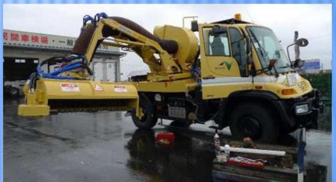
中央分離帯剪定用トレインブレードとその刃を装着した樹木剪定機（ウニモグ）
