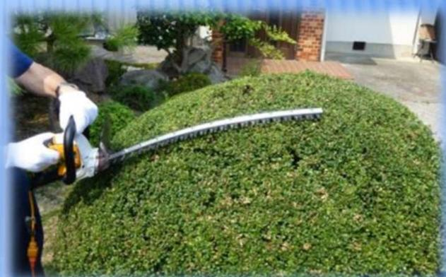
弧状形状ブレードによる玉づくり作業
